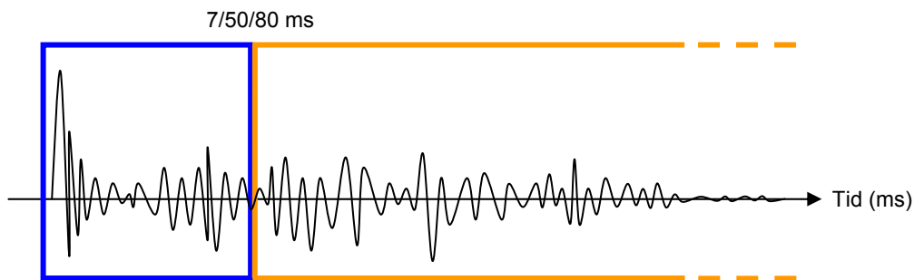
Figur 74: Inndeling av impulsresponsen i to deler for vurdering av tidsmessig tydelighet.
